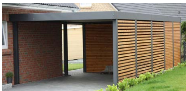
Carport à structure métal / remplissage bois
